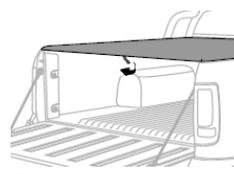
10 – Para abrir a capota, baixe a tampa da caçamba e manuseie a alavanca de alumínio do cabo de aço para os lados, até destravar as multitravas. Obs.: Utilize o mesmo processo para facilitar o fechamento da capota.
