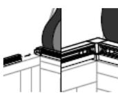
2 – Posicione o conjunto lona "A" na parte frontal, rente ao limite da caçamba e fixe com os parafusos retirados no passo anterior.
