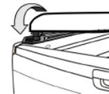
6 – Para o fechamento da parte traseira, encaixe as multitravas superiores nas inferiores. Repita no outro lado.
