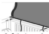
3 – Retire cinco parafusos laterais e coloque o perfil lateral "C" em sua posição, encaixando sua extremidade frontal na peça plástica presente no conjunto artefato de lona "A" com o auxílio dos parafusos já existentes na mesma.
