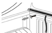
1 – Abaixar a tampa da caçamba. Retire os dois parafusos das extremidades que fixam o protetor de caçamba próximo a cabine.
