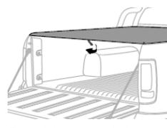
10 - Para abrir a capota, baixe a tampa da caçamba e manuseie a alavanca de alumínio do cabo de aço para os lados, até destravar as multitravas.
