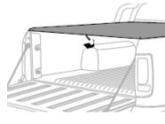
9 – Para abrir a capota, baixe a tampa da caçamba e manuseie a alavanca de alumínio do cabo de aço para os lados, até destravar as multitravas. Obs.: Utilize o mesmo processo para facilitar o fechamento da capota.
